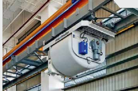
System transportu betonu
